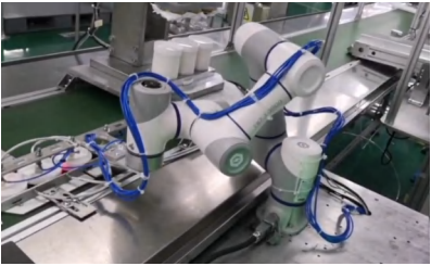
Chargement/déchargement de couvercles en plastique
