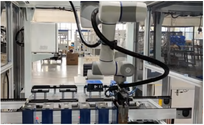
Chargement et déchargement (manutention) pour le test des batteries
