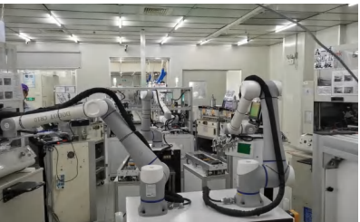
Gravure et manipulation de cartes mères d'appareils électroménagers
