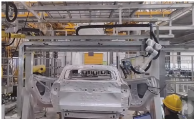
Assemblage de portières et de pièces de carrosserie
