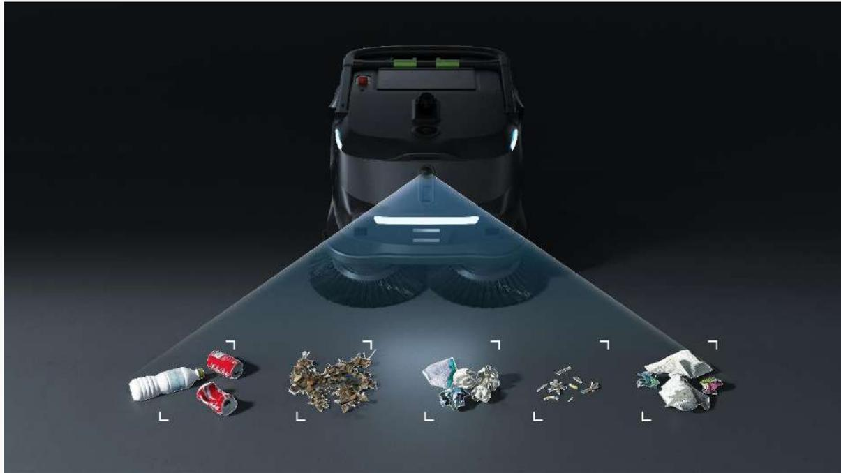
Le PUDU MT1 est équipé de caméras IA capables de reconnaître et d'identifier divers types de déchets en temps réel, en apprenant et en évoluant continuellement grâce à l'apprentissage en profondeur et aux mises à jour des bases de données.
