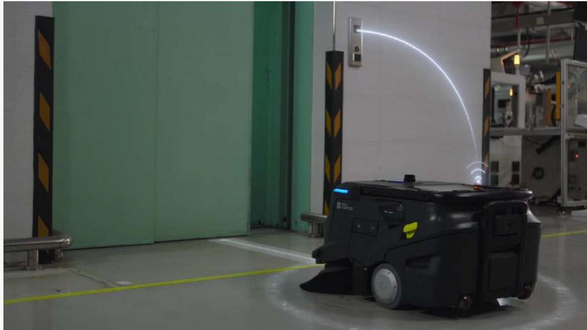
Le PUDU MT 1 s'intègre aux appareils IoT, interagissant avec les ascenseurs, les portails et d'autres infrastructures pour le nettoyage de plusieurs étages. La surveillance à distance via des applications et des interfaces PC fournit des mises à jour en temps réel, des rapports de nettoyage visualisés et des notifications lorsque la corbeille est pleine, assurant ainsi une gestion efficace.
