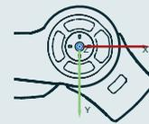
Ausrichtung Achse 7 ohne Endeffektor
