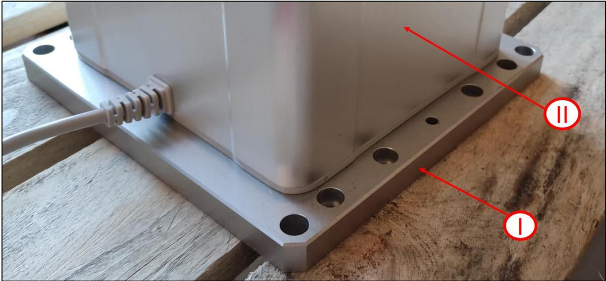
3. Fixer la platine de fixation inférieure au sol en utilisant les 12 trous de fixations M6 de la platine.
