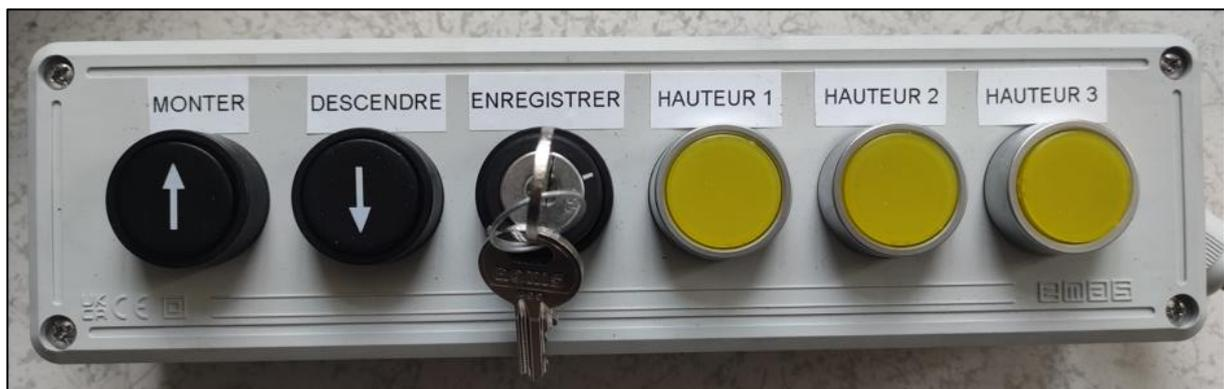
3. Le robot collaboratif a accès aux positions enregistrées dans « HAUTEUR 1 », « HAUTEUR 2 » et « HAUTEUR 3 ». Il peut donc commander la colonne pour qu'elle aille à ces différentes positions, une fois celles-ci enregistrées (voir section 6.2.2) :
