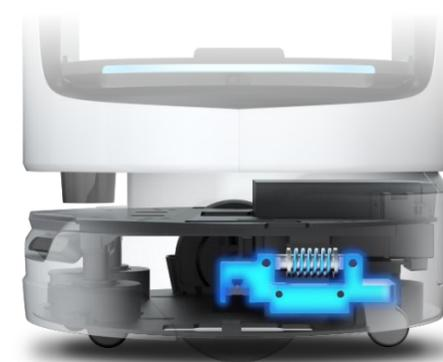
Suspension variable adaptative se mettant automatiquement à niveau. Le
