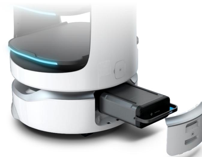
Les scénarios de rechargement et d' utilisation sont classés par catégories pour un remplacement plus rapide de la batterie.
